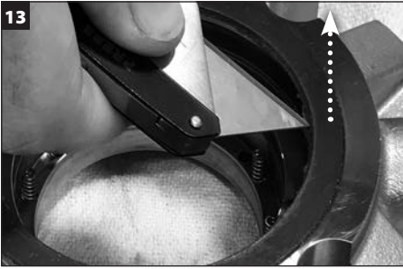
Salmastra bileziğinden salmastra yuvası yüzey contasını çıkarın ve atın.
